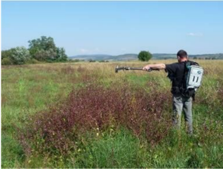
Referencia felület mérése ASD FieldSpec műszerrel
